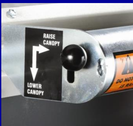
キャノピーパネル角度設定機構 (キャノピーパネル落下防止ロック)
